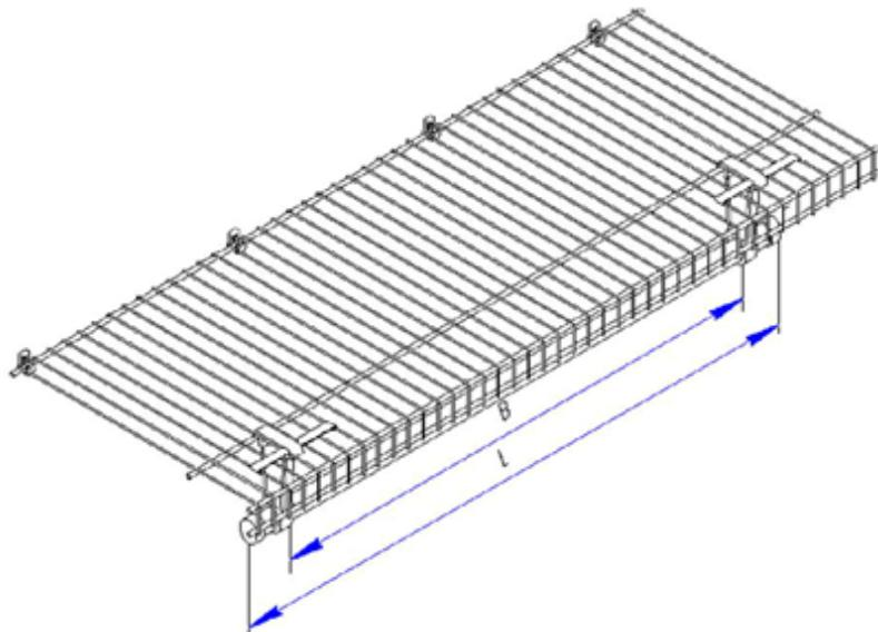
Кронштейн вешала устанавливается на сетчатую полку при помощи лепестка адаптера и жестко фиксируется на ней, исключая его выпадение.
